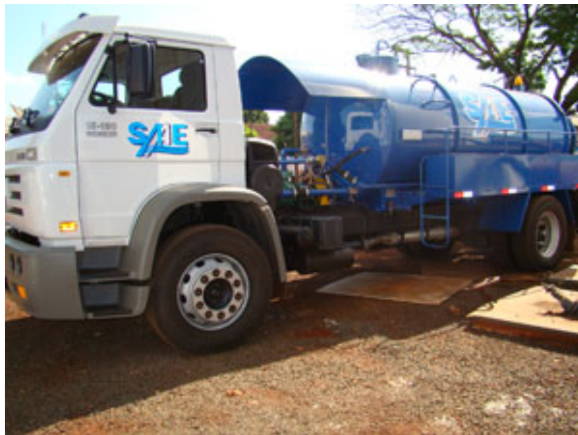
Figura 135. Caminhão com hidrojateamento de alta pressão para desobstrução de rede de esgoto existentes no SAAE de Cândido Mota
