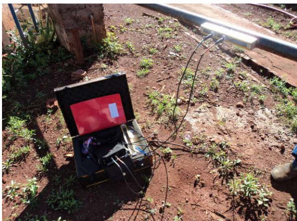
Figura 129. Medição de vazão com medidor ultrassônico no Poço P01
